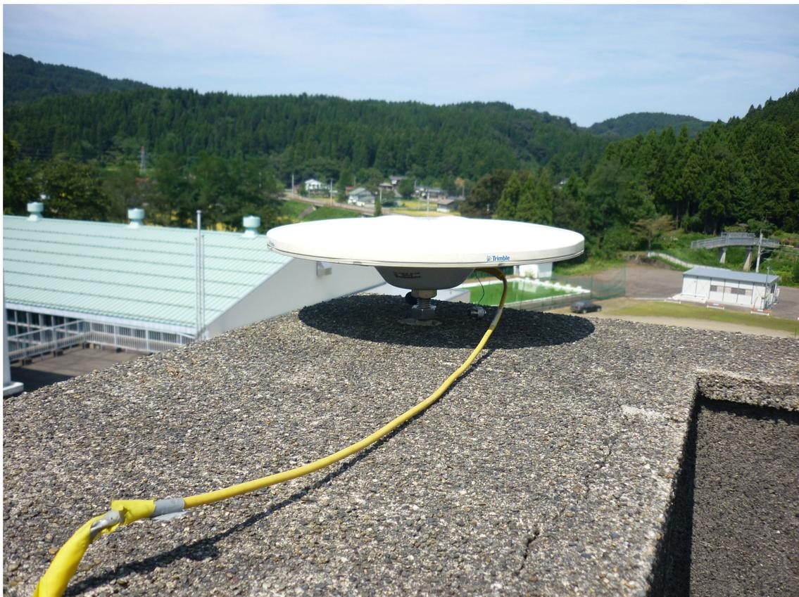
写真：GPS 受信機。衛星からの信号を受信するため、見晴らしの良い、小学校の屋上などに設置する。
